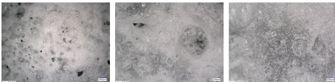
Fot. 1a. Zdjęcia mikroskopowe nawozu (ECRF1) o stosunku PLA do soli 50:50
