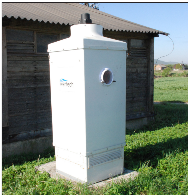
Fot. 2. Kompaktowy biofiltr do oczyszczania powietrza z chlewni (fot. J.Walczak)
