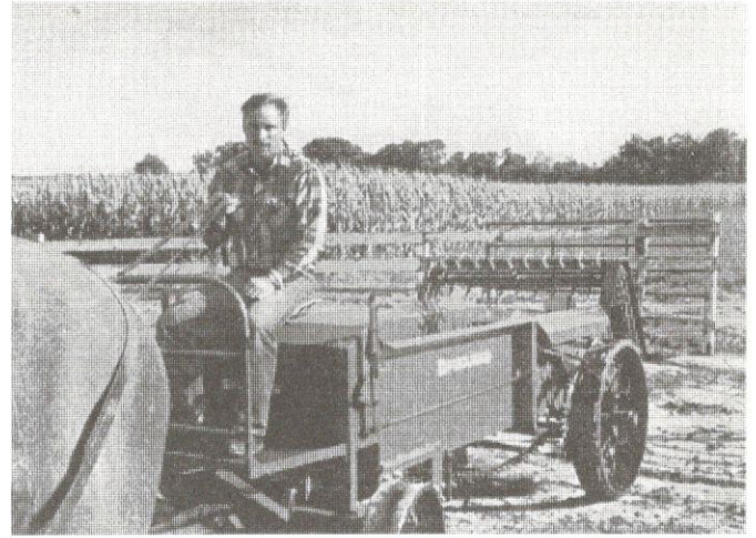
Fot. 4. Konny roztrzaskacz obronika z napędem od kół jezdnych, amerykańskiej firmy „Pequea”
