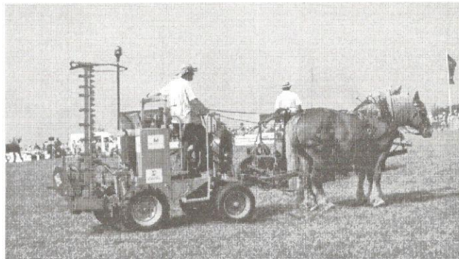
Fot. 2. Czterokołowy konny przodek roboczy z 3-punktowym zawieszeniem do narzędzi i maszyn traktorowych oraz napędem wałka poboru mocy przemiennie – od kół jezdnych lub silnika spalinowego, z zawieszoną kosiarką traktorową, belgijskiego farmera-konstruktora Rendersa (fot. E. Sasimowski)
