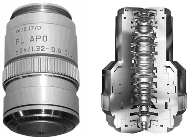
Rys. 6. Przekrój przez obiektyw Plan Achromatyczny o powiększeniu 63x, z regulowaną aperturą numeryczną (NA) od 0,6 do 1,32, immersją olejową, dla preparatów o grubości szkła nakrywkowego 0,17 mm. (wg www.leica-microsystems.com , zmieniłone)
